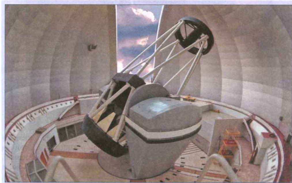
Рис. 124. Большой азимутальный телескоп Специальной астрофизической обсерватории Российской академии наук (БТА САО РАН). Диаметр его зеркального объектива 6 м
