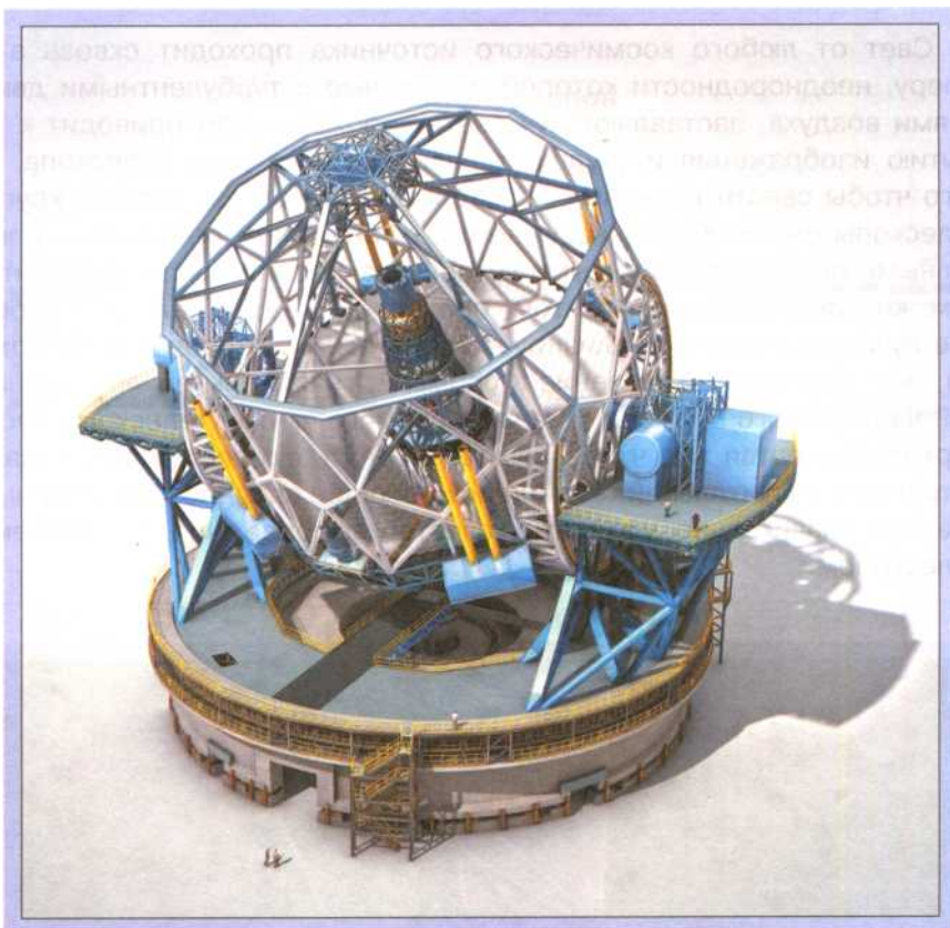
Рис. 125. Проект гигантского телескопа Европейской южной обсерватории с составным зеркальным объективом диаметром около 40 м
