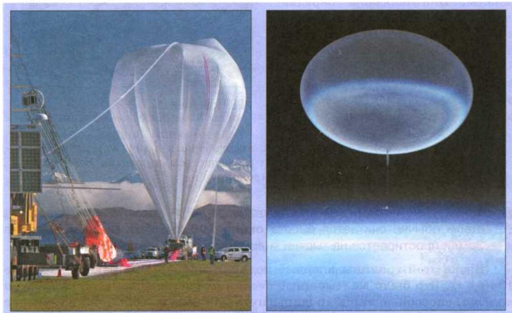
Рис. 12. Слева: многоразовый высотный стратостат, то есть аэростат, предназначенный для подъёма научной аппаратуры в стратосферу, на высоту более 11 км. Справа: стратостат в полёте
