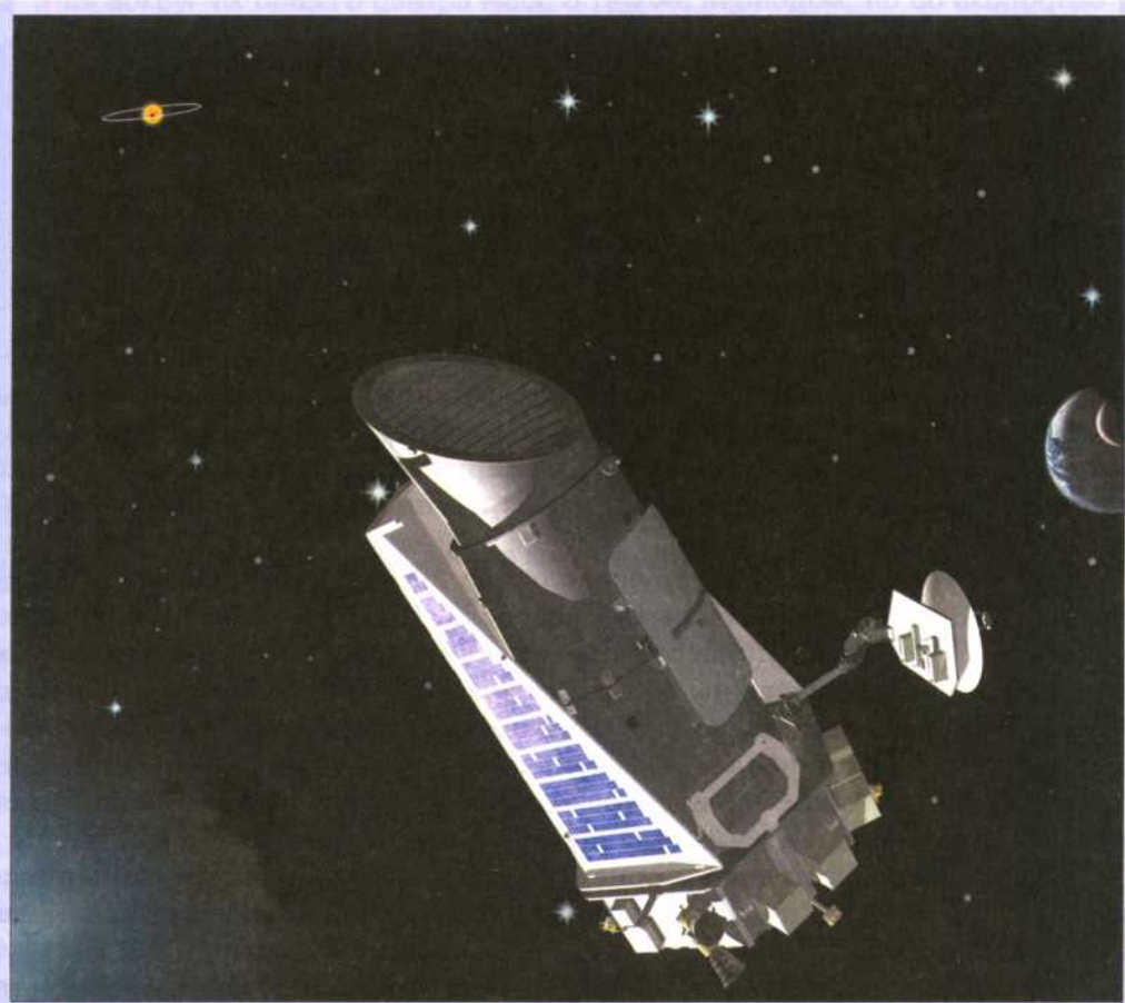
Рис. 120. Космический телескоп «Кеплер» (NASA) обнаруживает экзопланеты, наблюдая за их прохождениями на фоне звёзд
